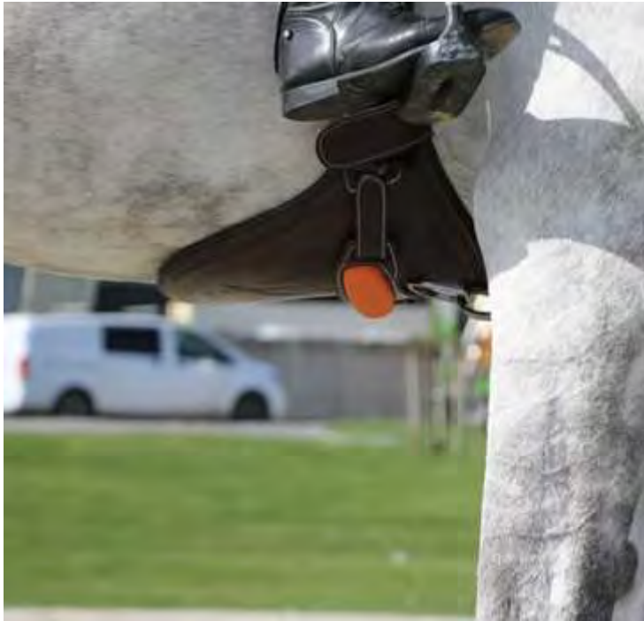
Figure 16 : Capteur Equisense Motion positionné sur la sangle
