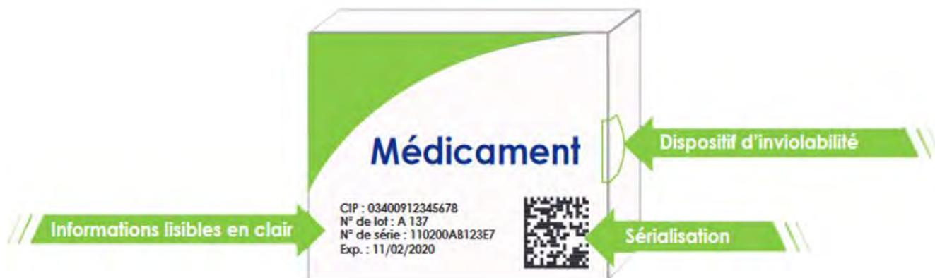
Figure 2 : Illustration représentant un médicament dans son conditionnement secondaire en appliquant les règles liées à la sérialisation
