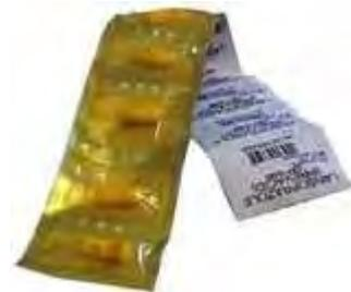
*Figure 8 : chapelet de reconditionnement de l'automate MPI Auto Print*
