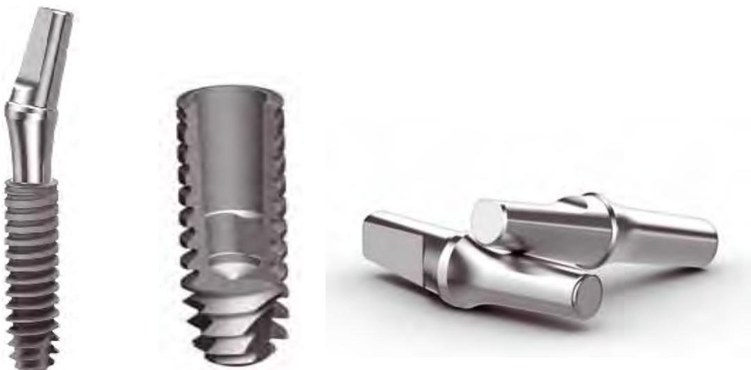
(Fig12) « Axiom 2.8 » de chez Anthogyr. L'implant fait 2,8mm de diamètre et possède un système cône morse à conicité de 3° avec un système anti-rotationnel trilobé: les piliers sont impactés à l'aide d'un instrument spécifique. [123]
