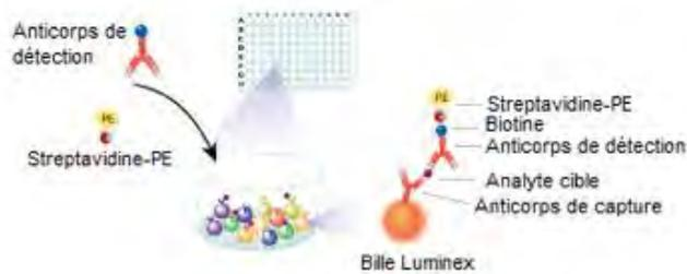
Les anticorps de détection biotinylés spécifiques de l'analyte d'intérêt sont ajoutés et forment un complexe anticorps-antigène. La Phycoérythrine (PE)-conjuguée à la streptavidine est ajoutée. Elle se lie aux anticorps de détection biotinylés.
