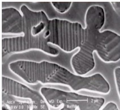
Figure 21: Image en microscopie électronique à balayage (MEB) d'une céramique dentaire feldspathique.
