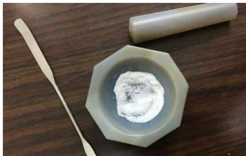
*Figure 22 : Mortier contenant le mélange d'échantillon broyé avec de la poudre de bromure de potassium*
