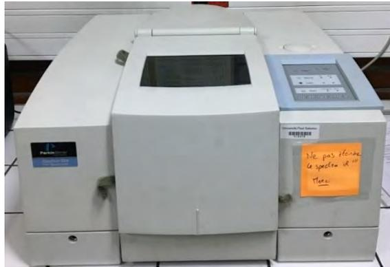
Figure 24 : Le spectromètre infrarouge Spectrum One® (Perkin Elmer Corporation® – Norwalk – Connecticut)
