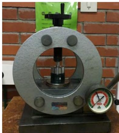
*Figure 23 : Le pilon métallique dans la presse*
