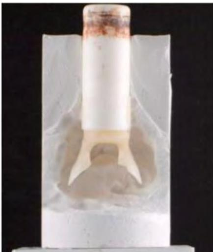
***Fig 3-12 :*** Mise en évidence du piston et des éléments pressés dans leur revêtement. Hélène et Didier Crescenzo
