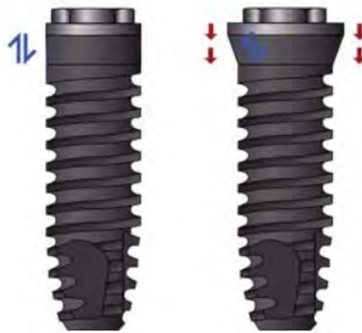
Figure 13: Répartition du stress sur deux implants présentant des formes de col différentes.
