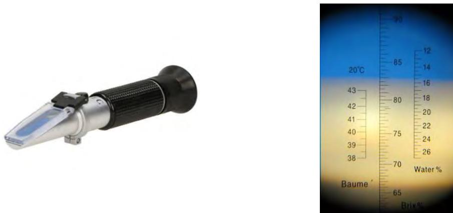
Figure 15 : Réfractomètre à lecture optique (50)
