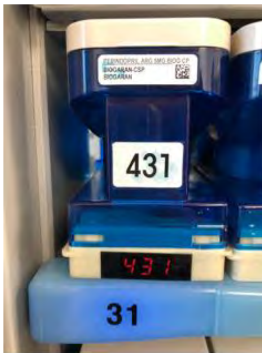
Figure 19 : Cassette disposée sur une base variable et dont le numéro change en fonction de la cassette apposée
