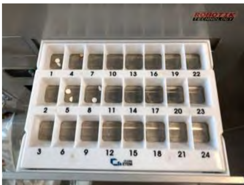
Figure 21 : Tiroir MDU en cours de remplissage
