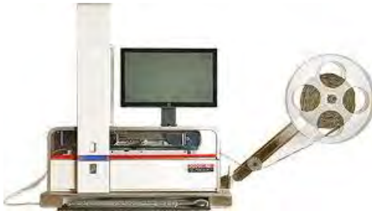
Figure 16 : Logiciel E VISION ® - Robotik Technology ® associé à la table de lecture optique et au dispositif de déroulage-renroulage automatique des chapelets (65)
