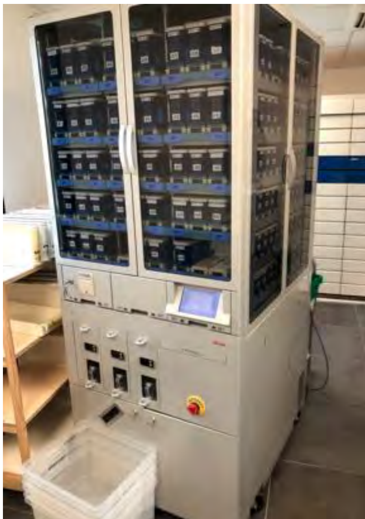
Figure 18 : Automate Robotik Technology® AP-405 dans le local dédié à la PDA à la Pharmacie du Pôle
