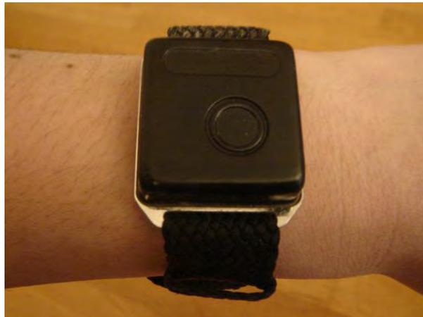
*Figure 7: Exemple d'un actimètre Actiwatch® (Cambridge Technology) [60]*
