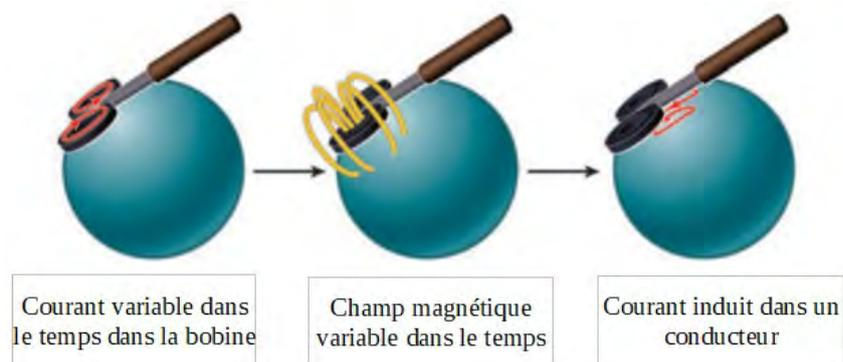
Figure 4: Induction électromagnétique d'une bobine de TMS (7).
