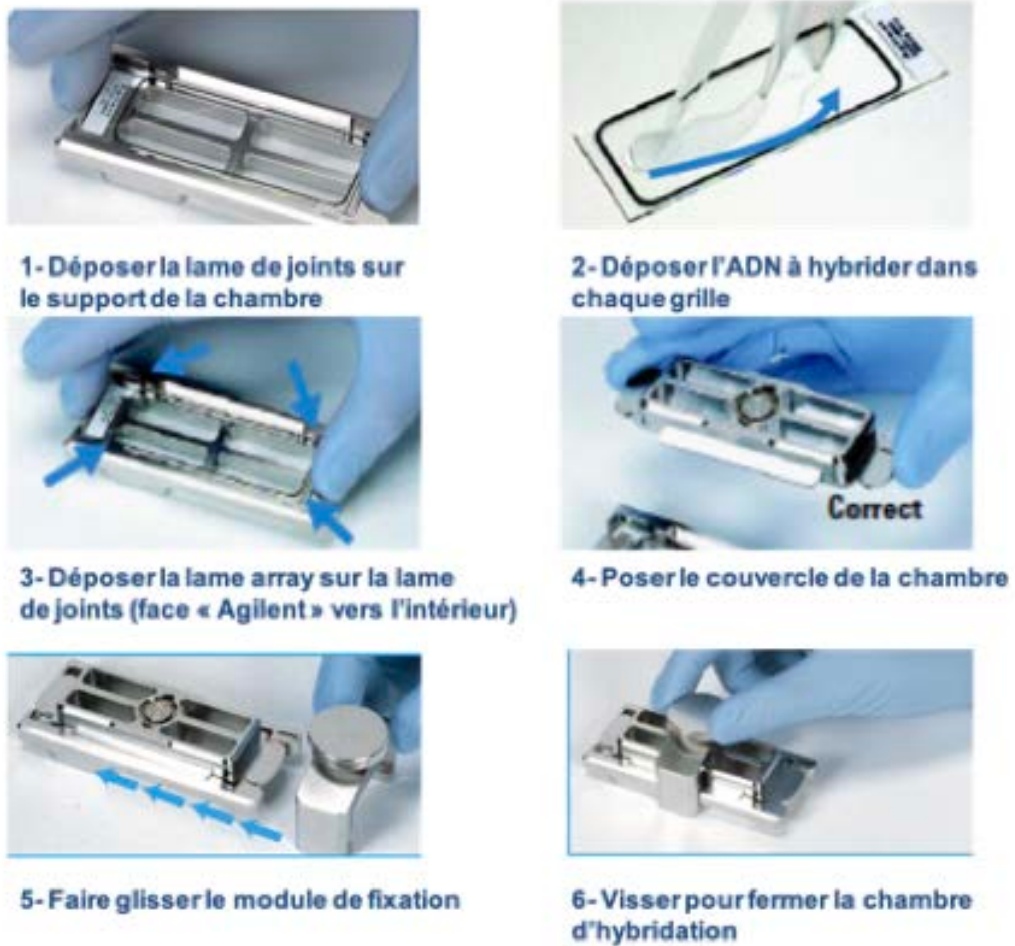
Figure 22: Fermeture chambre d'hybridation
