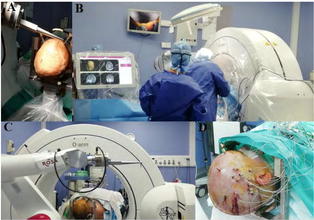
Figure 45 : Exemple de système ROSA au bloc opératoire de Grenoble. A : 5 fiduciaires osseux sont insérés dans le crâne du patient dans différents axes non coplanaires. B : Le robot ROSA et son écran tactile ainsi que le O-ARM (imagerie per-opératoire) C : Le système haptique de ROSA pour le référencement à partir de fiduciaires osseux D : Résultats post-opératoires immédiats d'une implantation SEEG droite.
