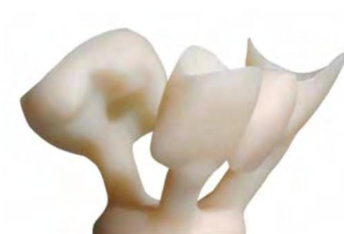
Figure 10. Restaurations en sortie de démoulage, avec leurs tiges de coulées. (Ivoclar - Vivadent)
