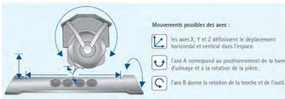
Figure 19: Exemple de mouvements 5 axes sur une machine Everest de Kavo (17).
