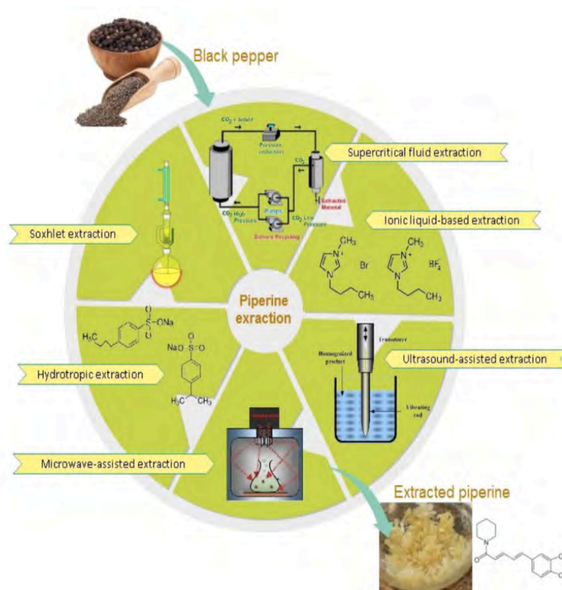
Figure 15 : Un schéma d'isolation de pipérine à partir de poivre utilisant différentes méthodes d'extraction. (Institute of Food Technologists 2016)
