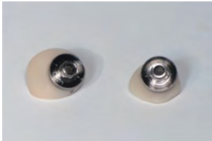
Figure 13 : Assemblage des pièces usinées (résine PMMA) aux piliers TiBase supra-implantaires 98
