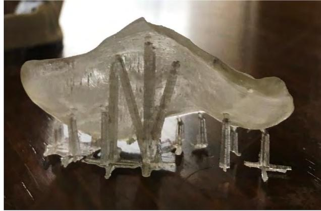
*Figure 11 Plaque palatine obturatrice imprimée avec ses piliers*
