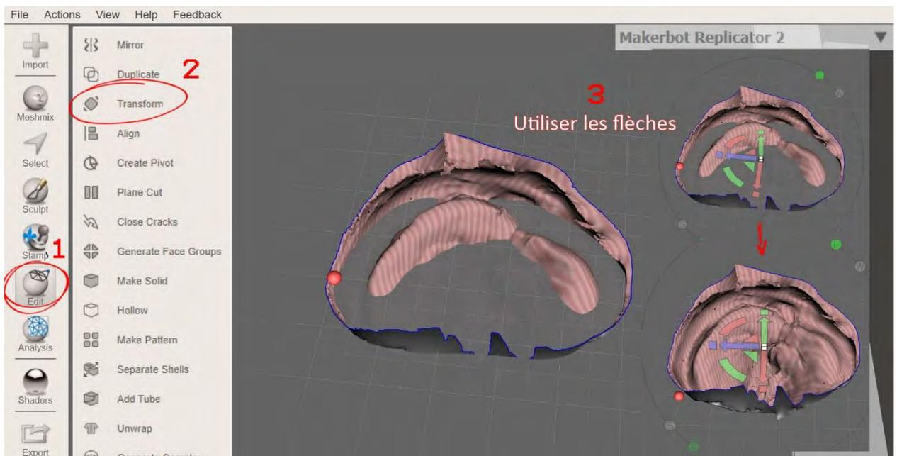
Dans le cas où il s'agit d'une empreinte scannée, il faudra inverser la sélection pour obtenir un modèle positif : cliquer sur **Select**, sélectionner la zone grise puis cliquer sur **G** pour étendre la sélection. Ensuite, cliquer sur **Edit** puis **Flip Normals**. On obtient une inversion de la zone grise (voir image 6).
