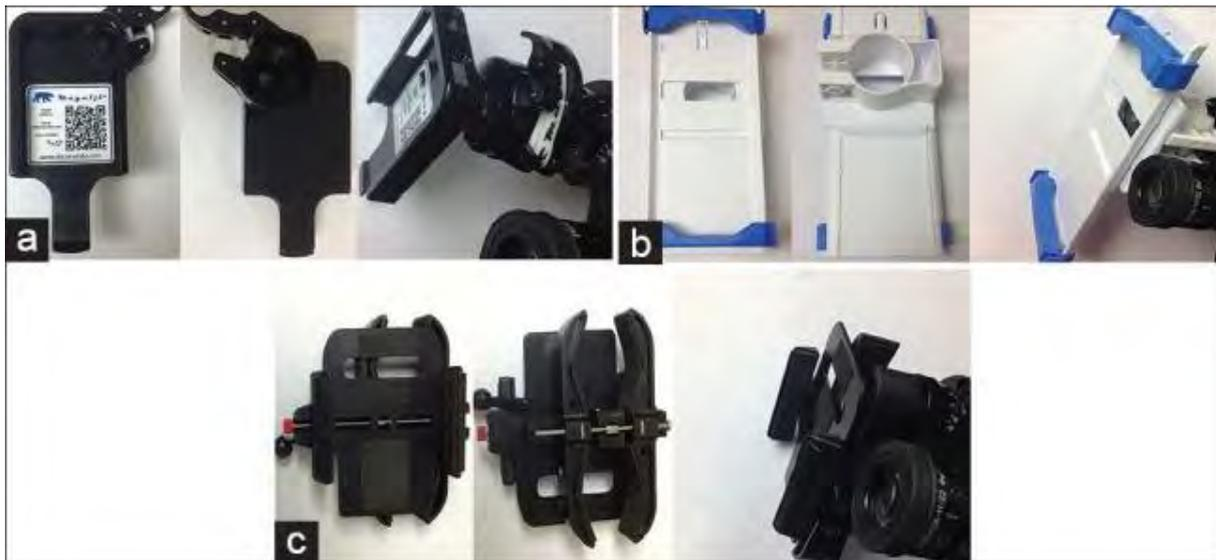
Figure 10: Adaptateur pour smartphone. (a) Magnifi (b) Skylight (c) Snapzoom (Roy S, 2018)
