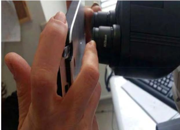
Un pathologiste (UPH) a capturé des images statiques de lames de l'oculaire d'un microscope (Nikon Eclipse Ni-U microscope, Nikon Corporation, Tokyo, Japon) en utilisant un smartphone (Samsung Galaxy Note II, 8 MPs, Made in Vietnam By Samsung). Les cellules et groupes de cellules cibles ont été marqués sur la lame de verre par le pathologiste avant la prise de vue. Le zoom numérique a été utilisé sur l'écran smartphone pour augmenter la taille de l'image.
