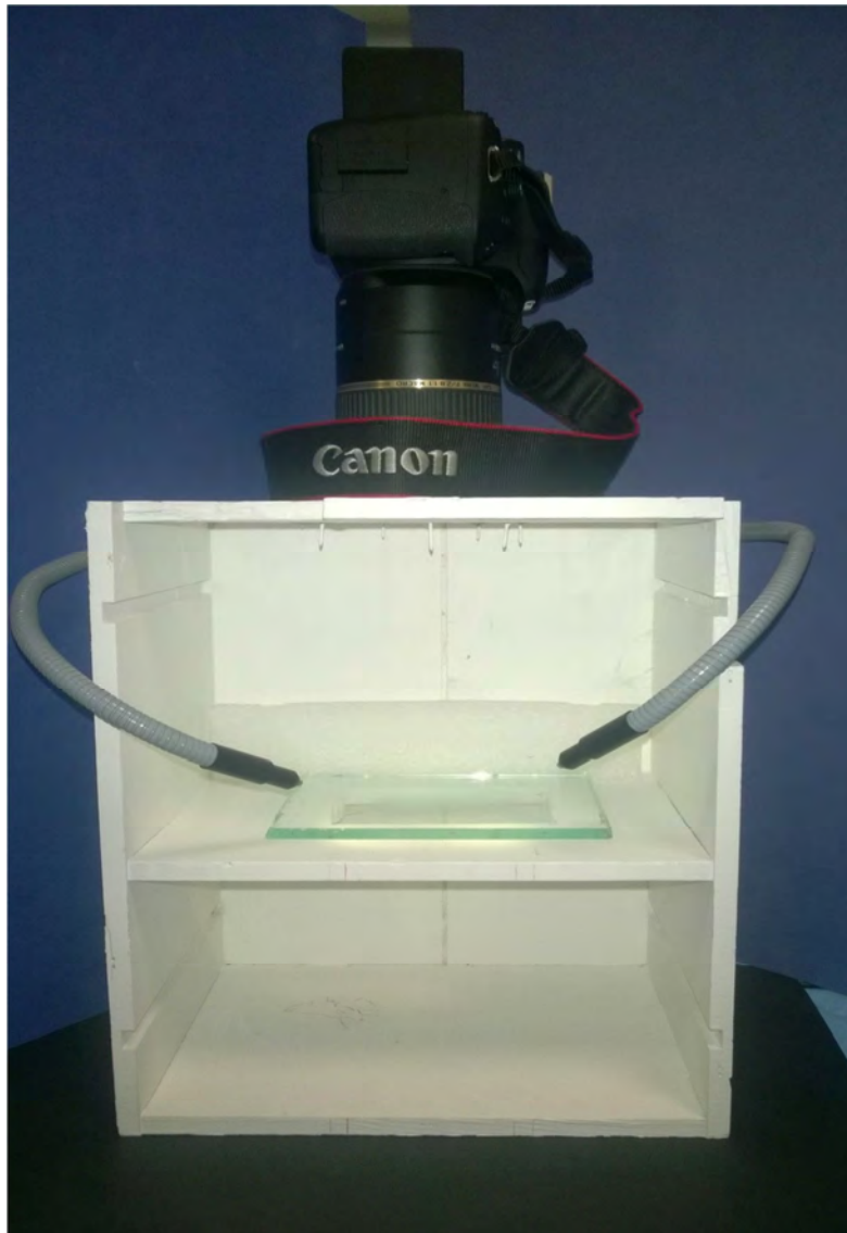
Figure 8 : Dispositif de prise de photographies standardisées.
