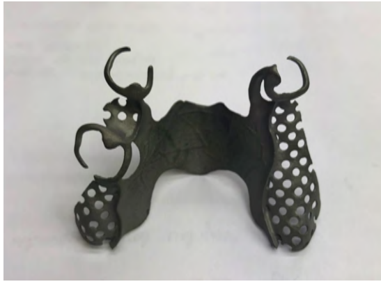
Figure 35 : Exemple d'un châssis maxillaire reçu du centre d'usinage non poli
