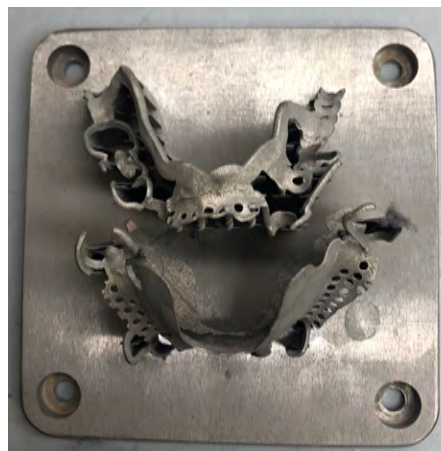
Figure 34 : Exemple de châssis sortant de la machine-outil encore sur leur support
