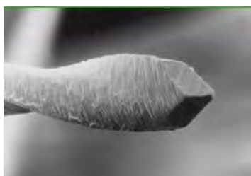
Figure 14 : pointe active du Mtwo® R en MEB, dentalweb.com
