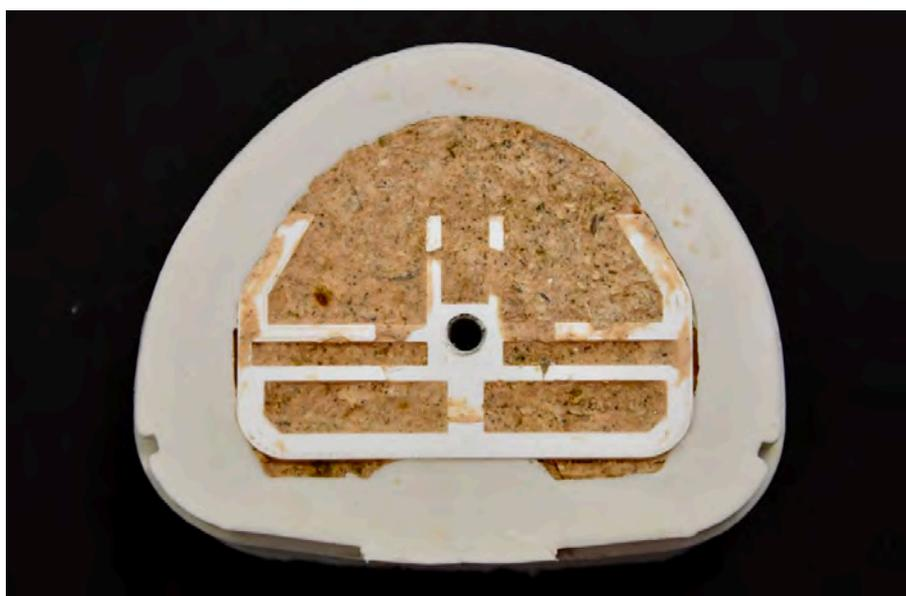
*Fig. 5 : Seconde coulée avec plaque support*
