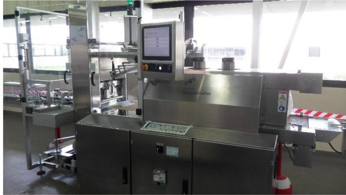
Figure 16 : Fardeleuse d'une ligne de Conditionnement
