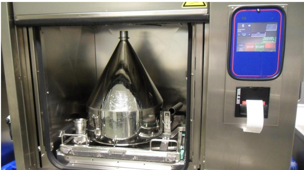
Figure 28 : laveuse contenant le panier supportant les pièces à nettoyer
