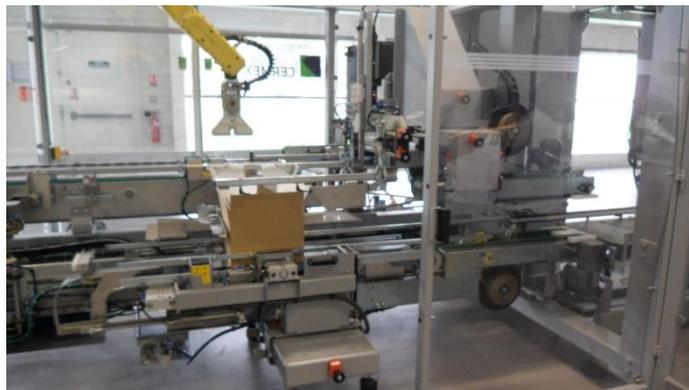
Figure 17 : Encaisseur
