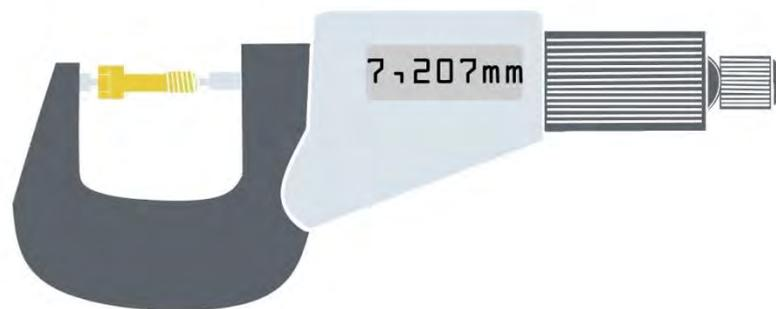
Figure 73 : Schéma représentant la mesure d'une vis à l'aide d'un micromètre électronique (Palmer)
