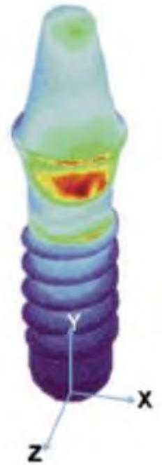
Figure 35 Distribution des contraintes au niveau de l'implant
