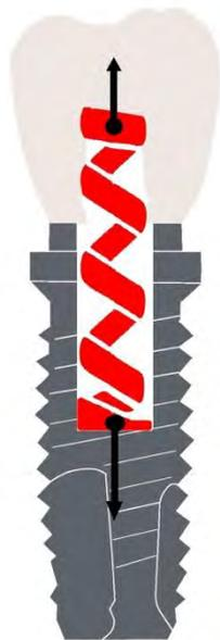
**Figure 40** Une vis agit comme un ressort qui assemble deux éléments. La vis est allongée et exerce une tension.
