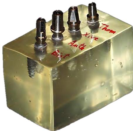
Figure 71 : Les 4 implants ont été coulés dans un bloc de résine acrylique, Réalisation Laboratoire Chaze
