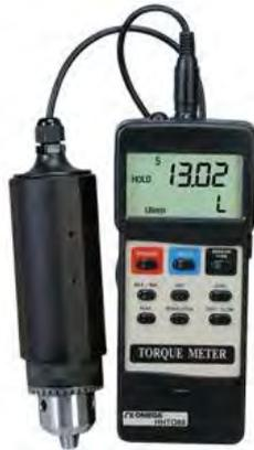
Figure 16 Jauge de couple électronique (Omega, 2018)
