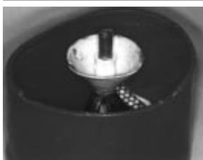
**13** Mise en place du modèle dans le cylindre. La base du cône de coulée affleure le sommet du cylindre.
