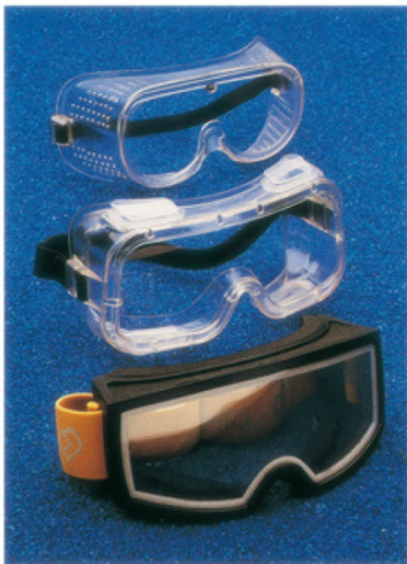
De haut en bas : lunette étanche aux poussières avec micro-perforations, lunette étanche aux gouttelettes avec aérateurs, lunette avec mousse filtrante, étanche aux gouttelettes, avec double écran (photo COMASEC).
