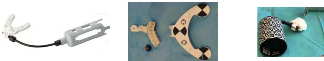
Figure 28 : Parties intra-buccales des systèmes avec le « tracker » pour l'IRIS-100®, Navident® et X-Guide®.
