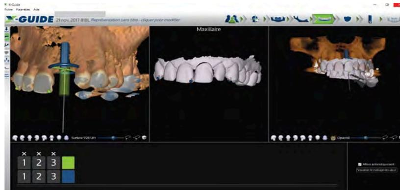
Figure 37 : Matching de la radiographie tridimensionnelle et d’empreinte optique intra-oral.
