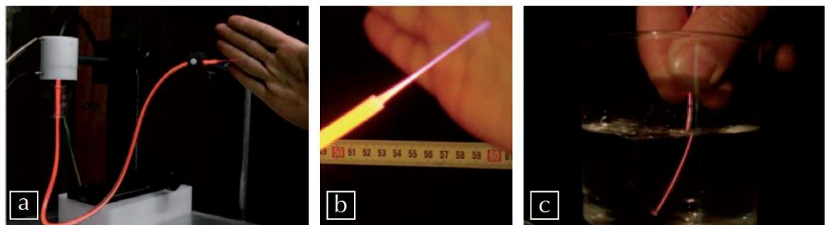
Système Plasma Gun mis au point par le Groupe de Recherches sur l'Énergétique des Milieux Ionisés (CNRS/Université d'Orléans). A. Vue générale B. Plume plasma générée C. Plume plasma débouchant dans l'eau. [3]
