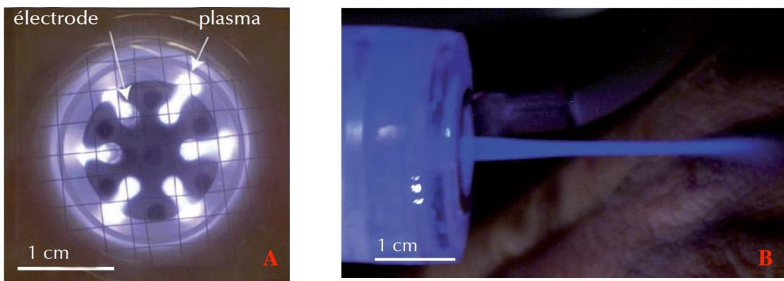
A. Jet de Plasma par radiofréquence. B. Jet de plasma par système de décharge à barrières diélectriques annulaires [3]
