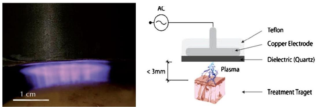
Système de décharge à barrières diélectriques à électrode flottante.
