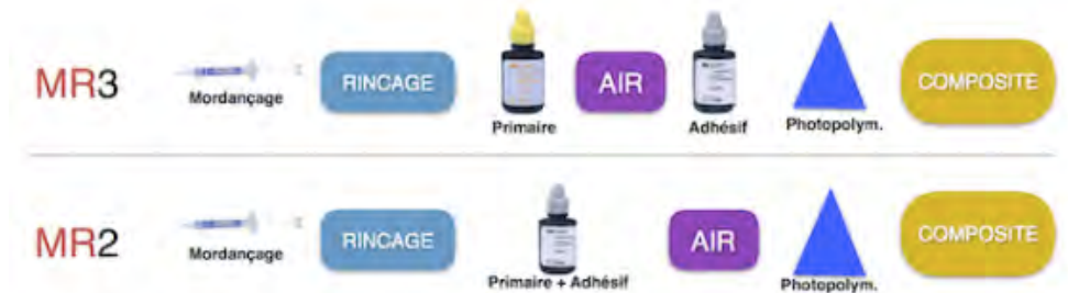
Figure 30 : Les différentes étapes de mise en œuvre des MR3 et MR2 [76]
