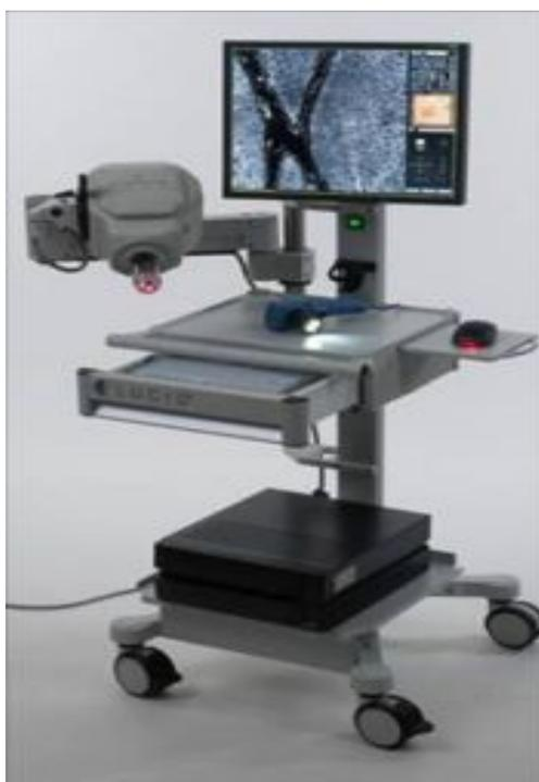
Figure 17 : Microscope confocale par réflectance [61]
