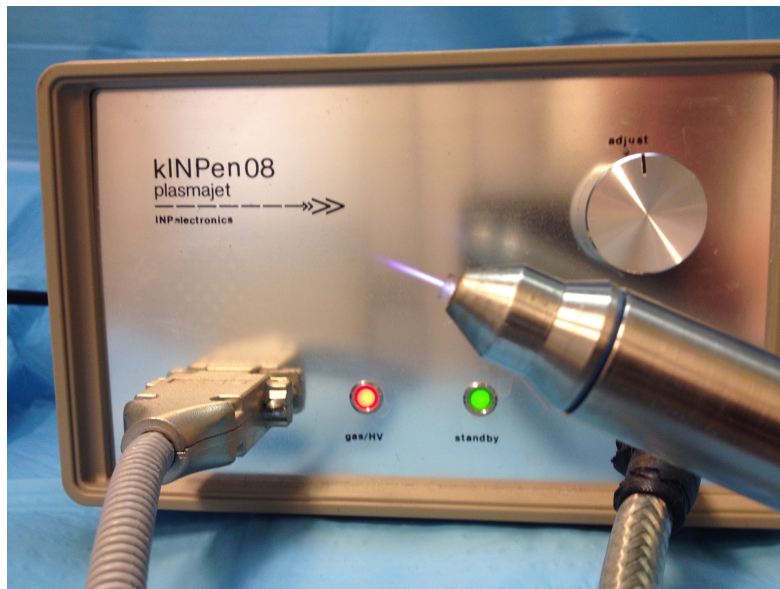
Figure 5 : Pièce à main kINPen ® 08, INP, Greifswald, Germany. (11)
