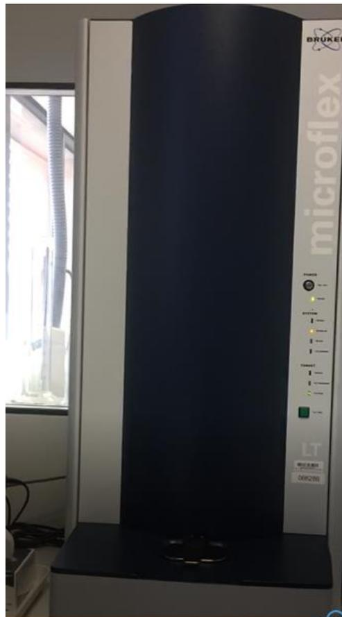
*Figure 29 : Spectromètre de masse*
