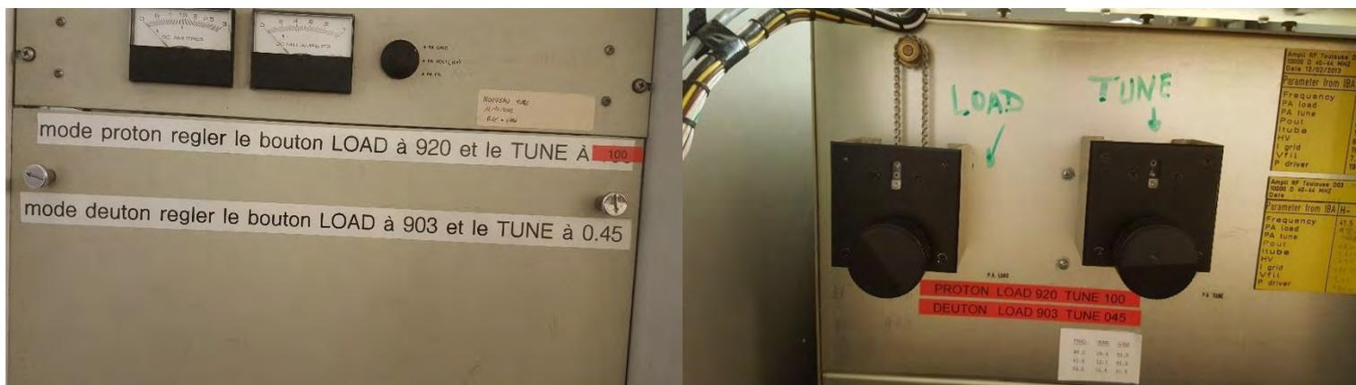
Les molettes de réglage se trouvent derrière la plaque métallique ci-contre. Pour accéder aux réglages il faut démonter cette plaque en dévissant les deux boutons qui se trouvent de part et d'autre de la plaque. Une fois le panneau métallique enlevé, on accède aux molettes de réglage.
