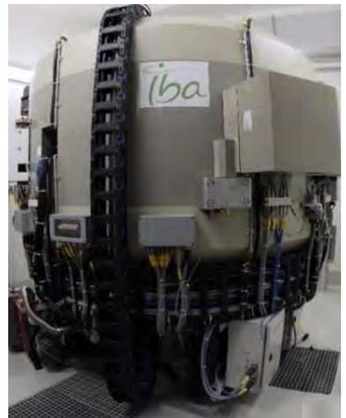
Figure 8 : Vue extérieure d'un cyclotron de la société iba
