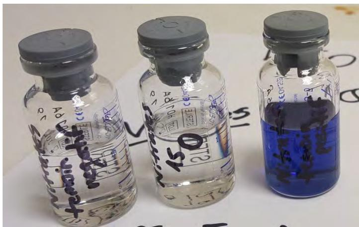
Figure 56 : Recherche d'impuretés de type nitrates : rendu colorimétrique (à gauche : Témoin négatif, au centre : l'échantillon analysé, à droite : Témoin positif)
