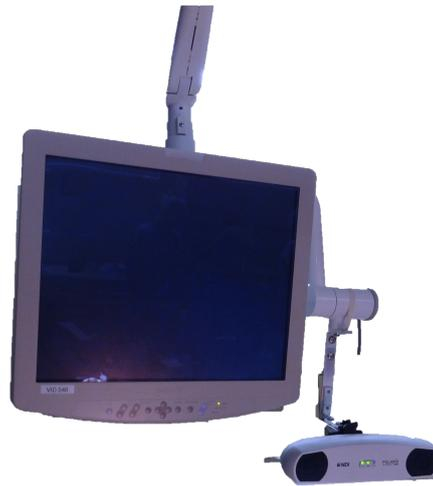
Figure 43 : Fixation de la camera sur écran déporté.
