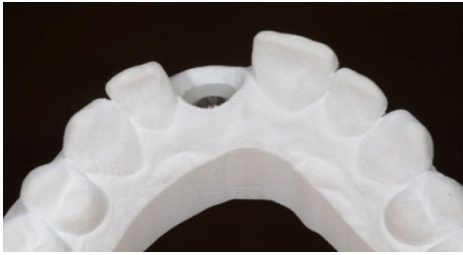
FIGURE 68 : Modèle stéréolithographique obtenu par impression 3D.
