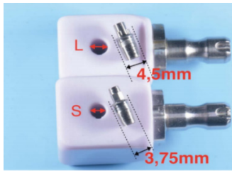
FIGURE 92 : Lingotin IPS e-max CAD (société Ivoclar Vivadent®) avec le trou qui varie en fonction du diamètre de l'embase.
