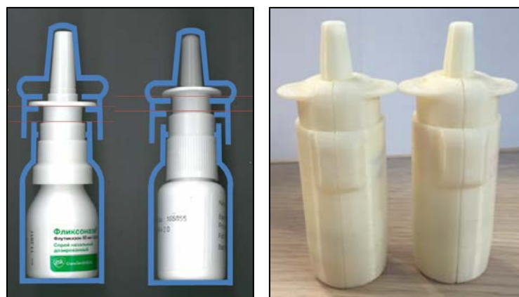
Figure 21 - Coque de masquage pour 2 dispositifs nasaux de forme et taille différentes
