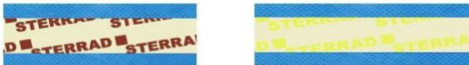
*Figure 31: ruban adhésif indicateur de passage Sterrad® (74)
