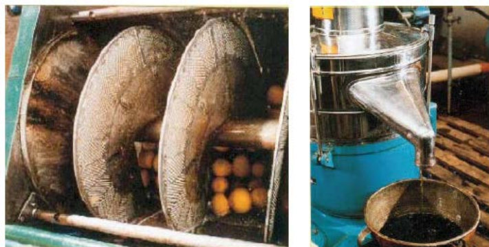
Illustration 28 : Pélatrice (gauche) / Centrifugeuse séparant l'essence des eaux résiduelles
