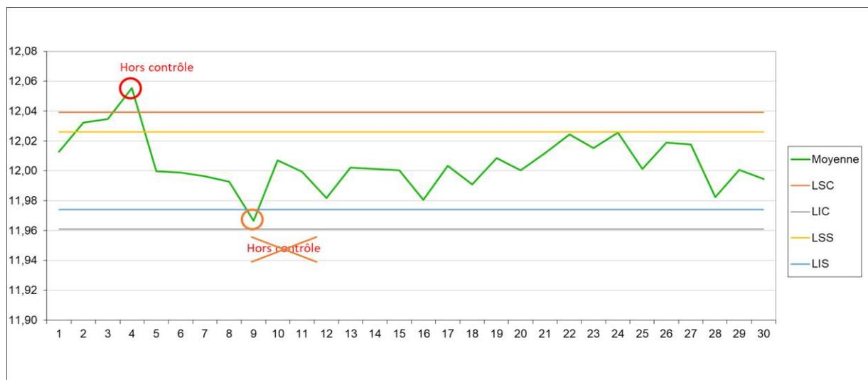
Figure 29 : Exemple d'une carte de contrôle
