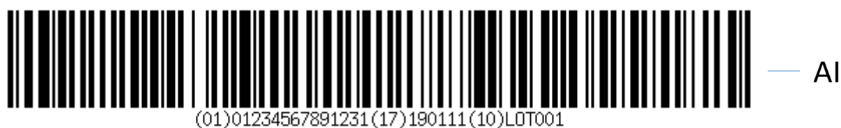
Figure 2 Exemple de code GS1-128 avec GTIN péremption et lot
