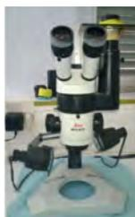
**Figure 27 :** Microscope optique binoculaire <sup>[34]</sup>
