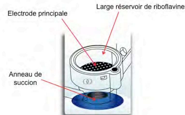
**Figure 15:** Représentation schématique du dispositif de l'électrode principale: cupule posée sur la cornée, maintenue par un anneau de succion et contenant la grille-électrode
