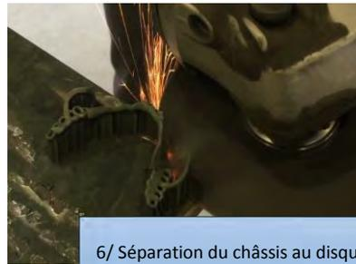
6/ Séparation du châssis au disque
