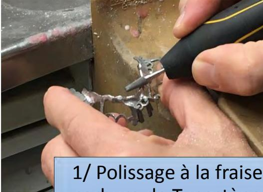
1/ Polissage à la fraise carbure de Tungstène
