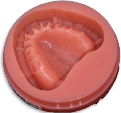
*Figure 34 Bloc de résine usiné (extrados, pied des dents)*
