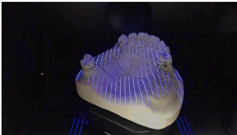
Figure 91: Scannage du modèle ( logiciel Dental System).[35]
