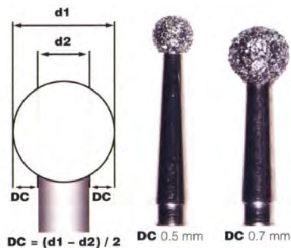
Figure 59 : Exemple de fraises boules utilisées pour de la pénétration contrôlée.(23)
