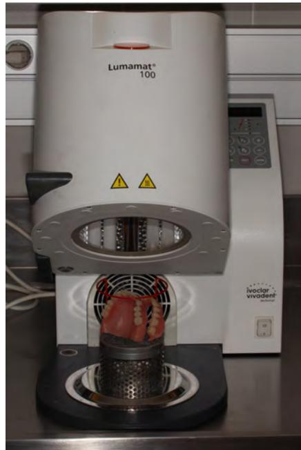
*Figure 10 - Prothèse dans le four avant polymérisation*
