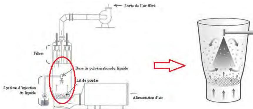
Figure 10 - Principe du lit d'air fluidisé
