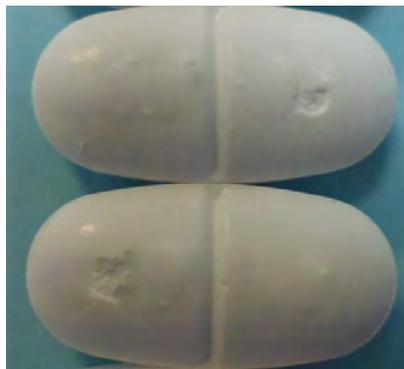
*Figure 17 - Photo de comprimés avec arrachage*
