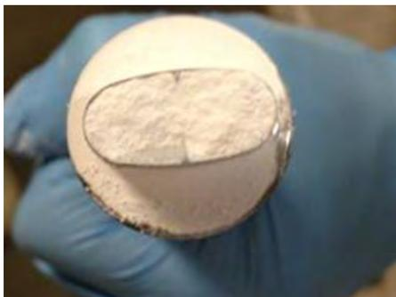
*Figure 16 - Photo d'un phénomène de collage sur poinçons*
