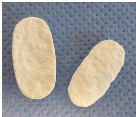
*Figure 18 - Photo d'un comprimé clivé*
