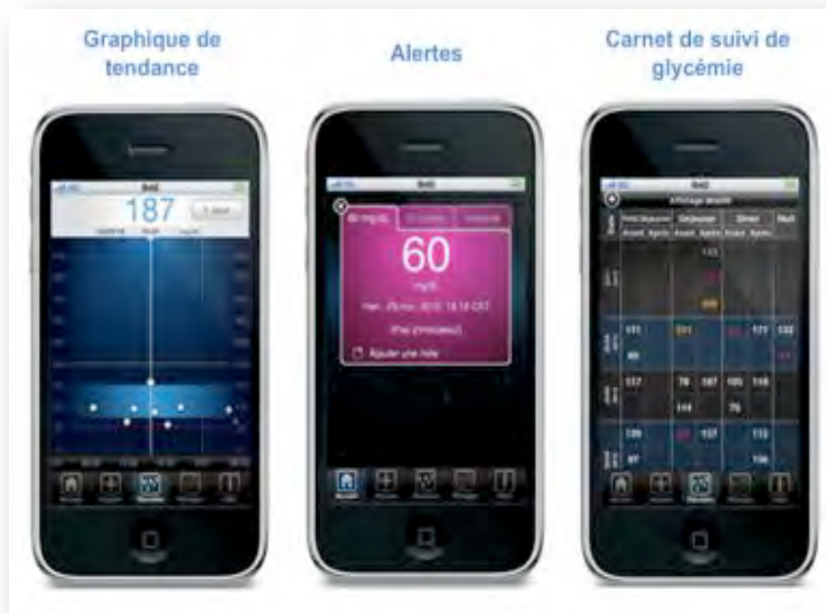
Figure 8 : Exemples de tableaux de bord visualisables sur le smartphone connecté au lecteur de glycémie iBGstar [modifié à partir de 30 ] : le graphique des tendances positionne les valeurs dans le temps, des alertes en couleurs s'affichent selon les valeurs de glycémie ; ici le rose indique une valeur inférieure à la limite d'hypoglycémie. Enfin, le carnet de glycémie permet de noter les valeurs à différent moment de la journée.
